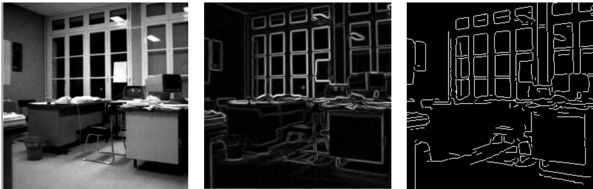
(a) image originale (b) image obtenue par un filtrage (c) image obtenue par un chainage
