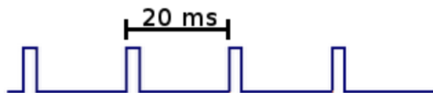
Figure III.10 : Période T du PWM pour un servomoteur [58].
