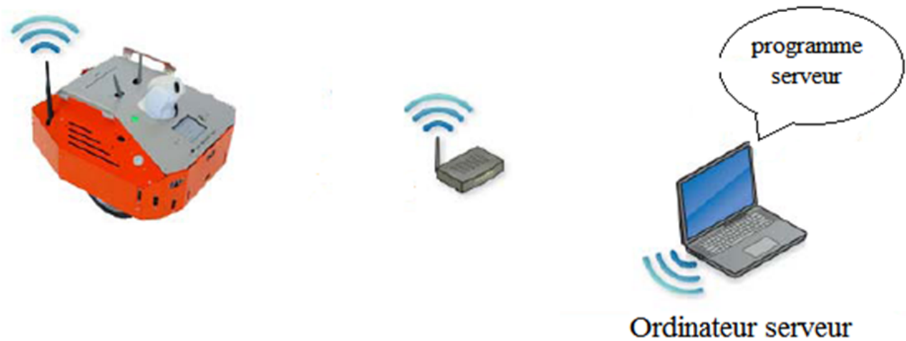
FIGURE 4.4 – Connexion sans fil du système de robot i90
