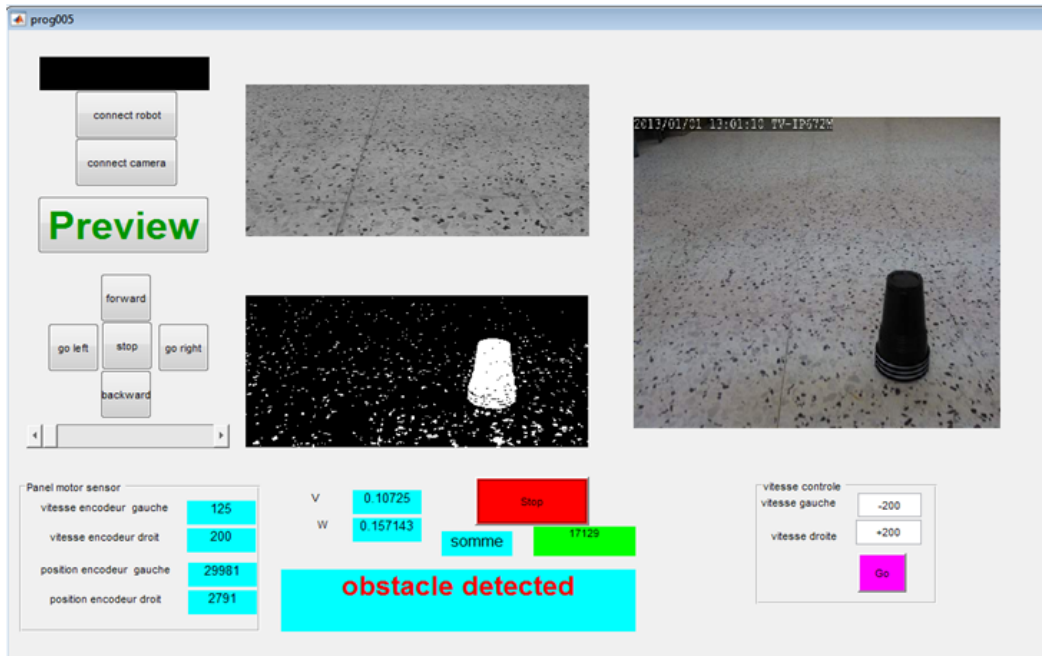
FIGURE 4.26 – Interface utilisateur créée pour la navigation du robot i90 avec évitement d’obstacles
