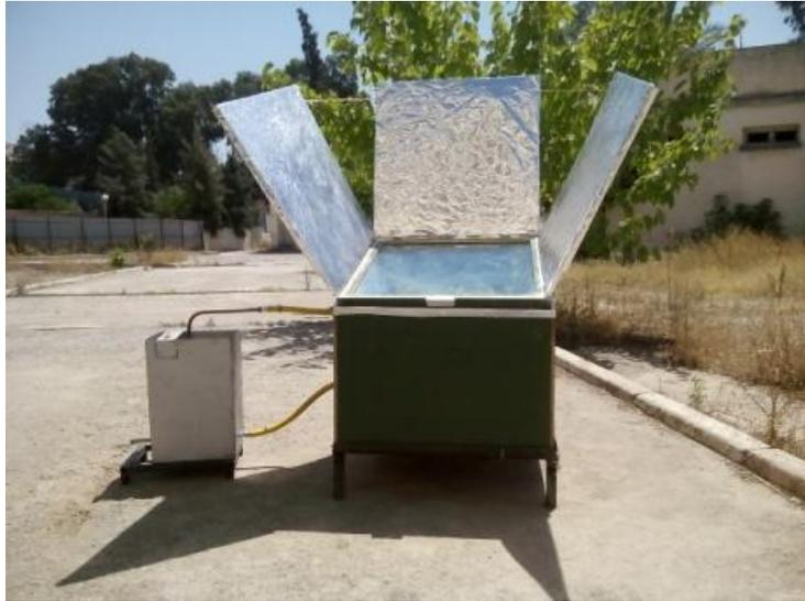
**Figure (IV.10) Distillateur solaire**
