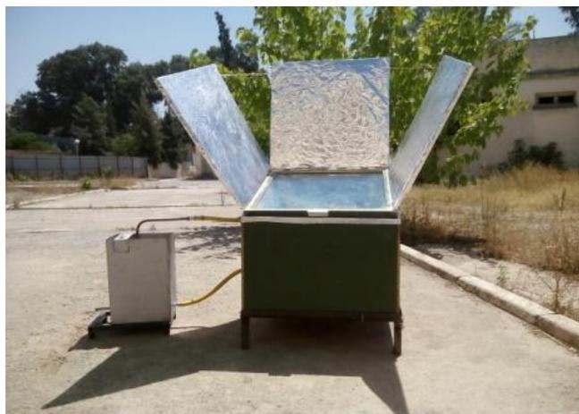
Figure(IV.1) distillateur solaire
