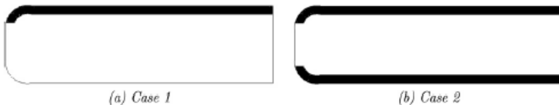
Figure 2.3 : Corps d'Ahmed à culot droit équipé de milieux poreux sur le pavillon (à gauche) et sur le pavillon et le soubassement (à droite) [07].
