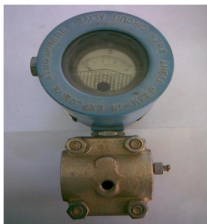
Figure II.6: Transmetteur de débit
