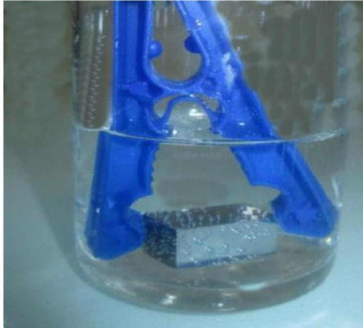
Fig. II.4 Dispositif expérimental de la technique de perte de masse
