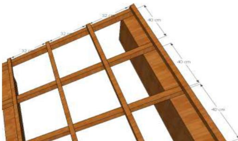
Figure III-38 : Disposition des liteaux sur les chevrons.
