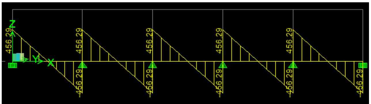
Figure IX-8 : Diagrammes des efforts tranchants aux KN à l'ELS au sens X-X.
