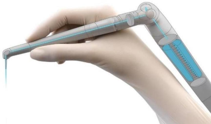
**Fig.8** : Pièce à main du laser Er: YAG [24]
