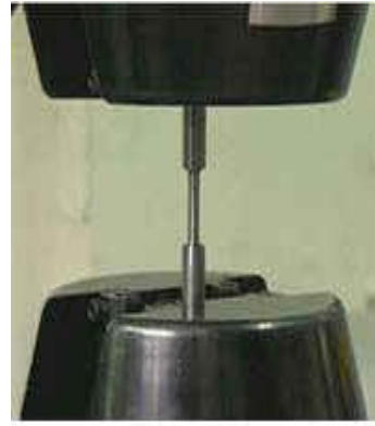
Figure I.4.7. Montage de l'éprouvette entre les deux mors de la machine de traction.
