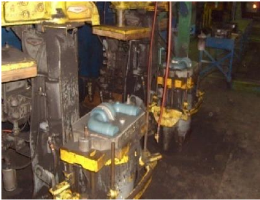
Figure II.1.7. Poste pour le moulage en sable
