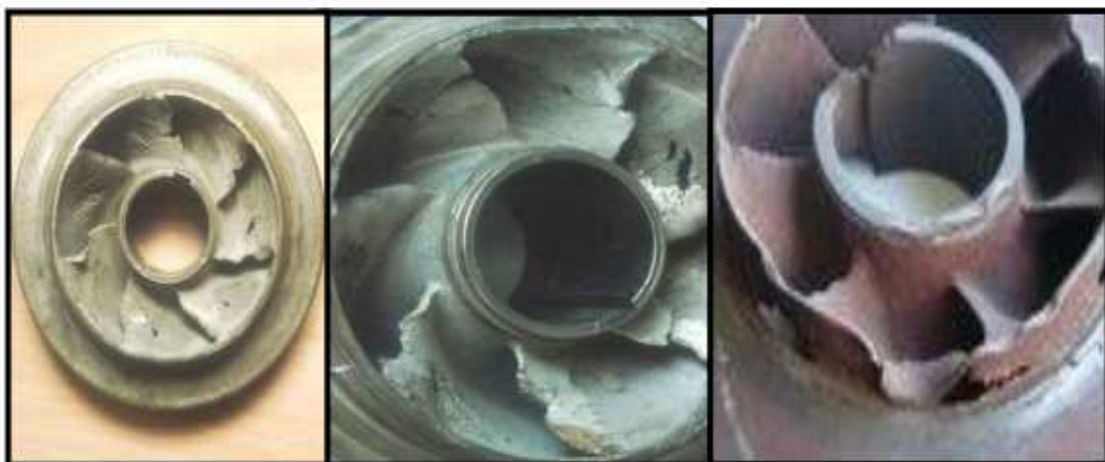
Figure V.9 Photos illustrant le phénomène de cavitation sur les aubes d'une pompe centrifuge
