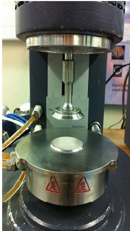
Figure IV.4.1. Les rhéomètres (AR2000ex de TA instrument): Schématique usagé pour test « probe-tack ».
