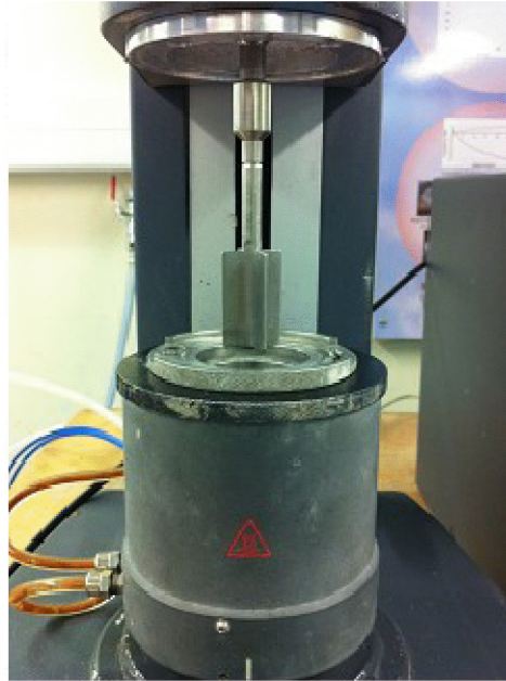
Figure IV.5.1. Le rhéomètre utilisé pour les expériences (AR2000ex de TA instrument) : Schématique usagé pour “Rhéologie”
