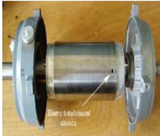
Figure I.22. Photo d'une barre cassée (réalisation artificielle) [1].
