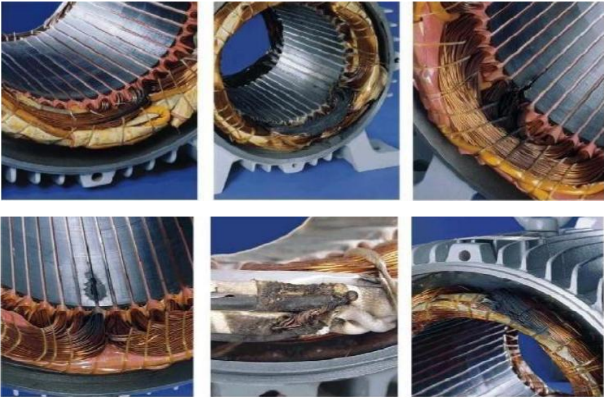
Figure I.20 : Différents défauts statoriques de la machine asynchrone [12]
