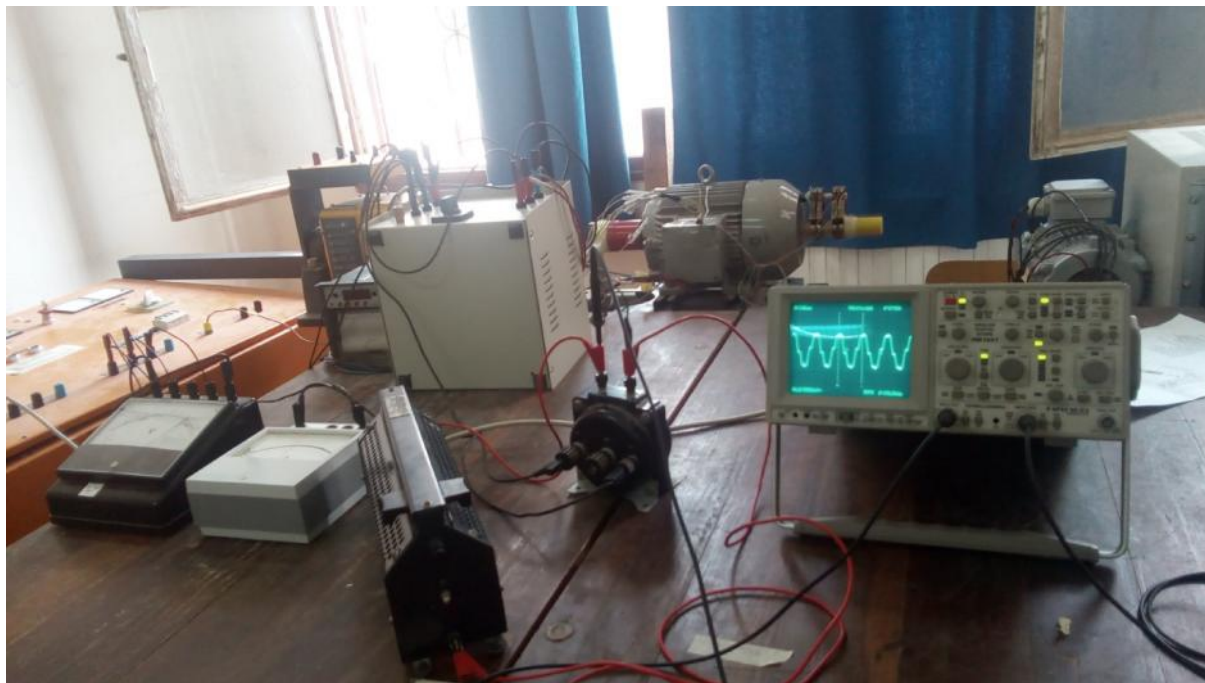
Figure A27: Le banc d'essais comprenant le moteur, ainsi que les organes de mesure et d'acquisition.
