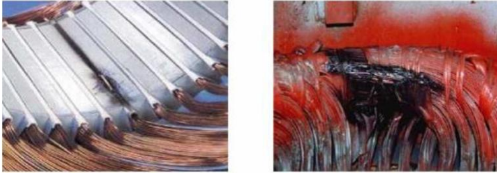
Figure I.19 : Machine avec défaut de court-circuit statorique [12].
