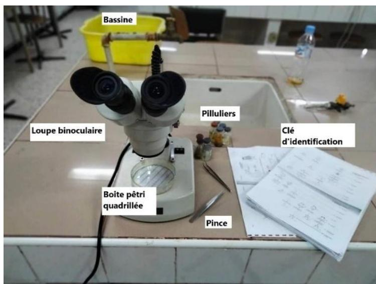
Matériels utilisés pour l'analyse et l'identification
