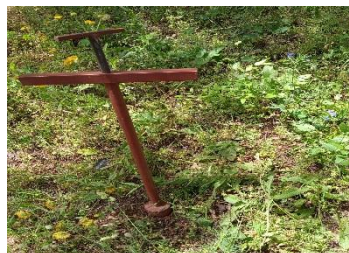
Figure 13 : Prélèvement du sol à l'aide d'une tarière (Photo originale, 2022).
