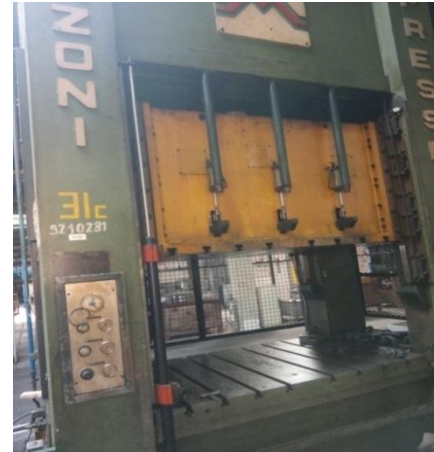
Figure IV.13 : Presse T31 Cexcentrique.
