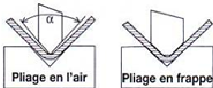
Figure II.8: Différence entre le pliage en air et en frappe.
