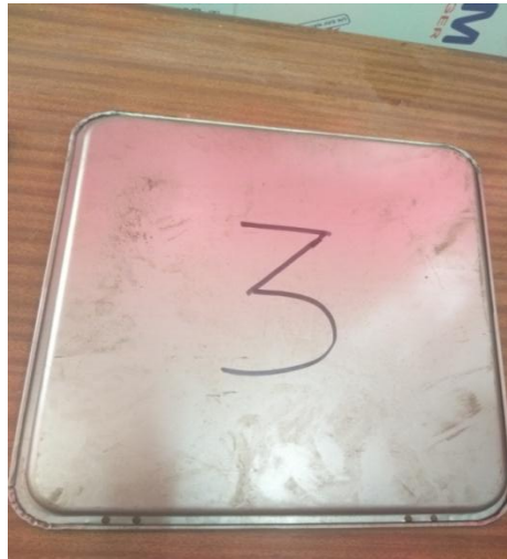
Figure III.8: Lèchefrite (pièce finie).
