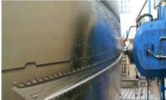
Figure I.5 : Exemple de détourage d'une pièce.
