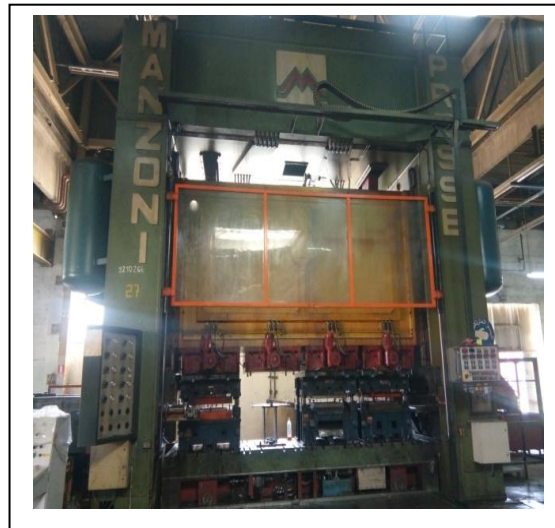
Figure IV.9 : Presse T 27 excentrique pour la fabrication en série.
