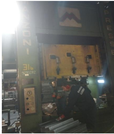
Figure IV.11 : Presse T 31 B excentrique.
