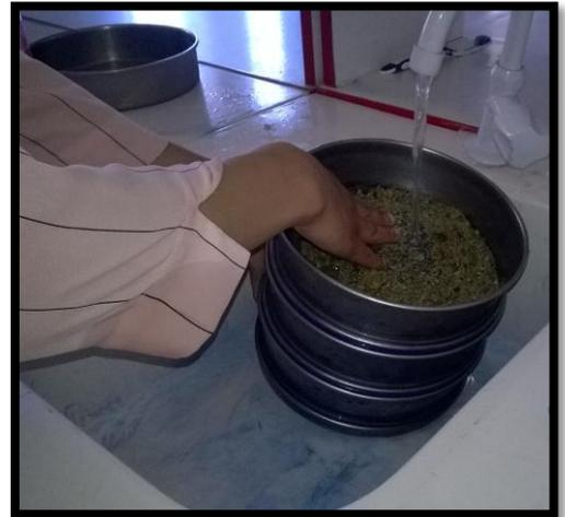
**Fig. I.06 :** Le sédiment désagrégé, est tamisé sous un jet d'eau.
