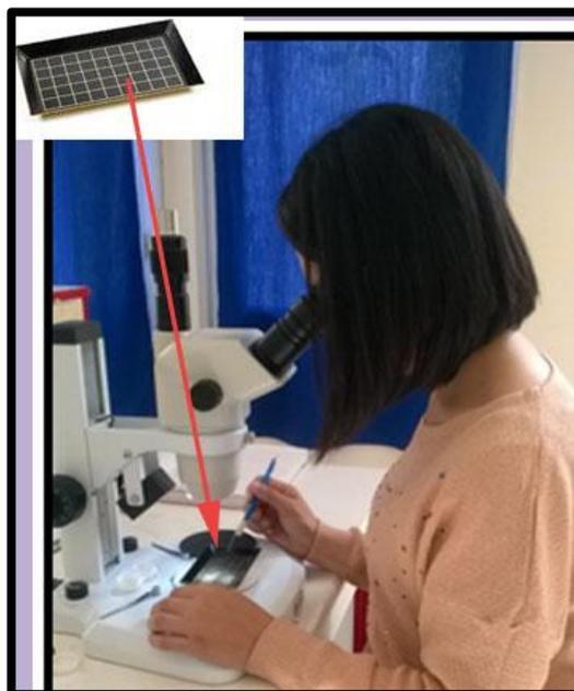
**Fig. I.08:** Cuvette de tri, quadrillée à fond noir et un pinceau de tri.
