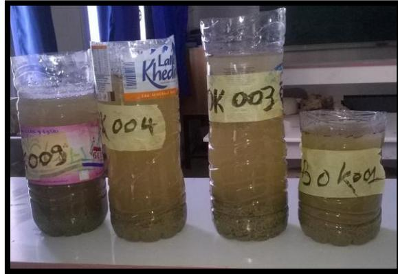
**Fig. I.03 :** Les marnes trempées dans l'eau ordinaire.
