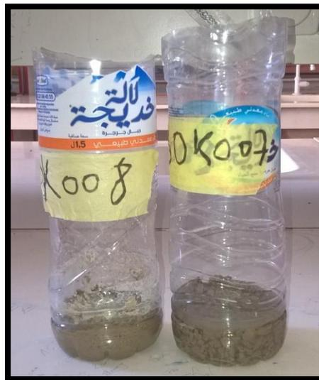
**Fig. I.04 :** Les marnes trempées dans l'eau oxygénée.
