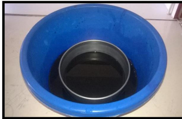
**Fig. I.07:** Tamis trempés dans une solution de bleu de méthylène.
