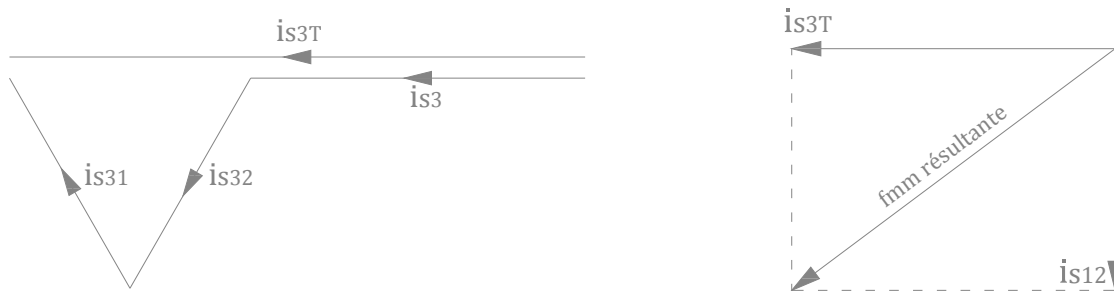
FIGURE 5.2—Alimentation de la phase 3 – Diagramme vectoriel
