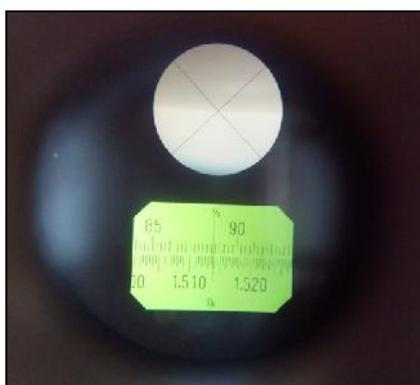
Figure 44: lecture du résultat au réfractomètre [75].
