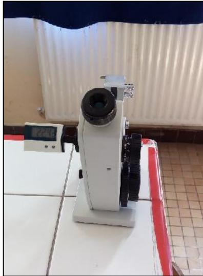
**Figure 16:** le réfractomètre d'Abbe [75].
