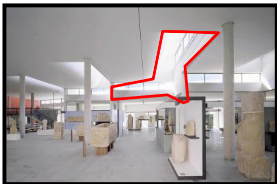
Figure V-13, V-14: des sheds dans les toitures qui réfléchissent l'éclairage sur les œuvres pour mettre en valeur les collections.
