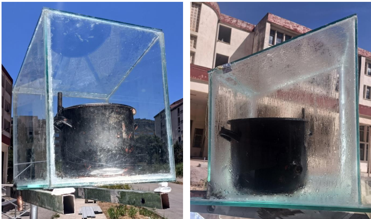
Figure V-22 : L'enceinte en verre avant et après la production de vapeur
