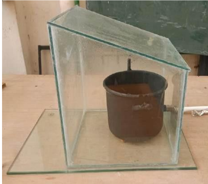
Figure IV-41 : Le dispositif de distillation (marmite dans une enceinte en verre)
