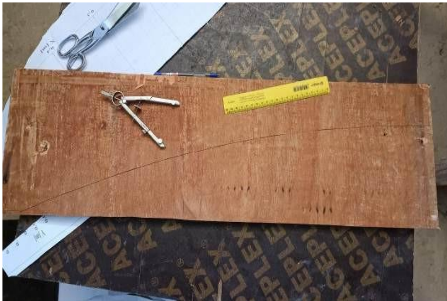
Figure IV-17 : Découpage de la demi-courbe sur une plaque en bois.
