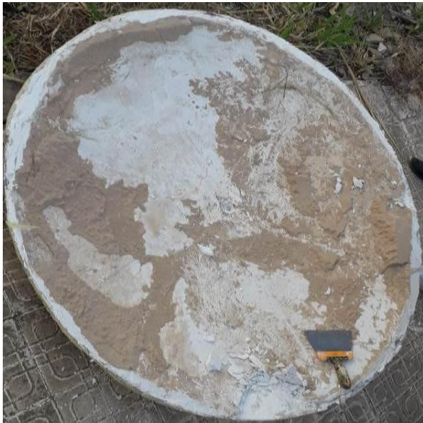
Figure IV-36: Démoulage de la parabole
