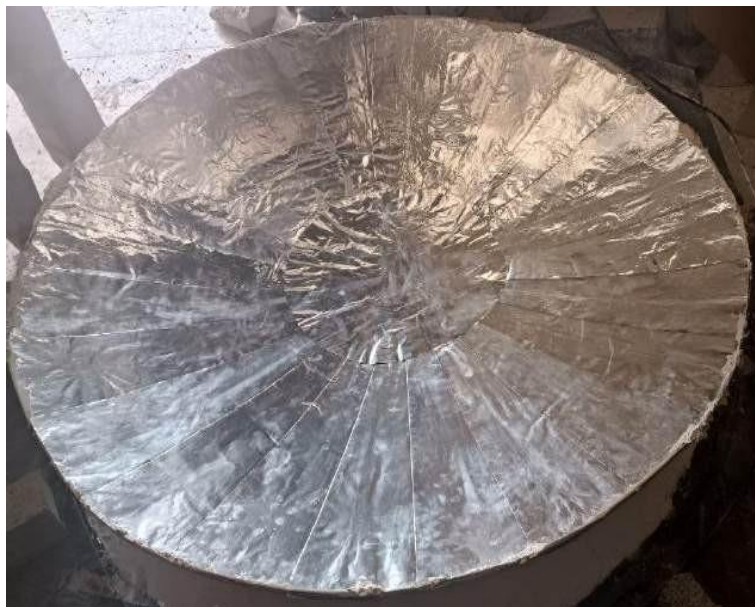
Figure IV-28 : Démoulage de la parabole
