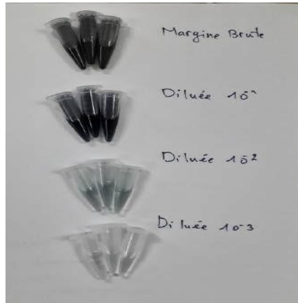
Figure IV-15 : Margines après ajout du \text{Na}_2\text{CO}_3
