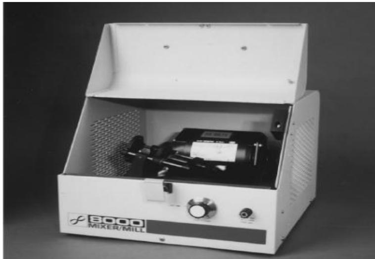
**Figure .II.4. :** Broyeur vibratoire type SPEX 8000
