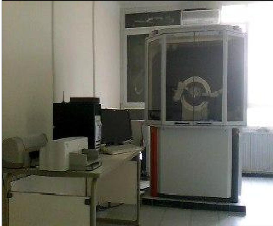
**Figure II.9.** Photographie du diffractomètre BRUKER AXS D8 ADVANCE .
