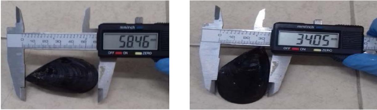
**Figure 11:** Méthode de mesure de la moule par le pied coulisse.
