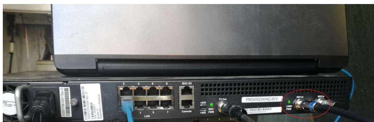
Figure 3.33 : connecter le LNB au routeur X7.
