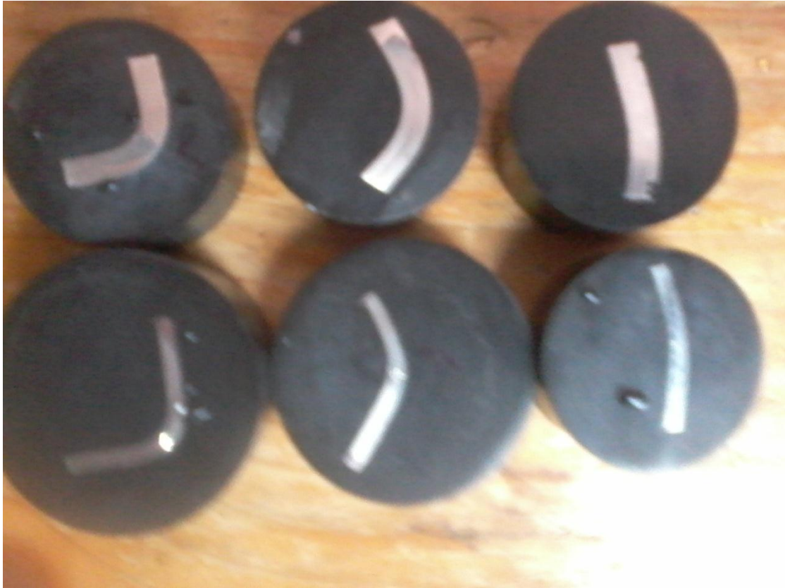
Figure. II.3. Les échantillons après pliage pour micrographie.
