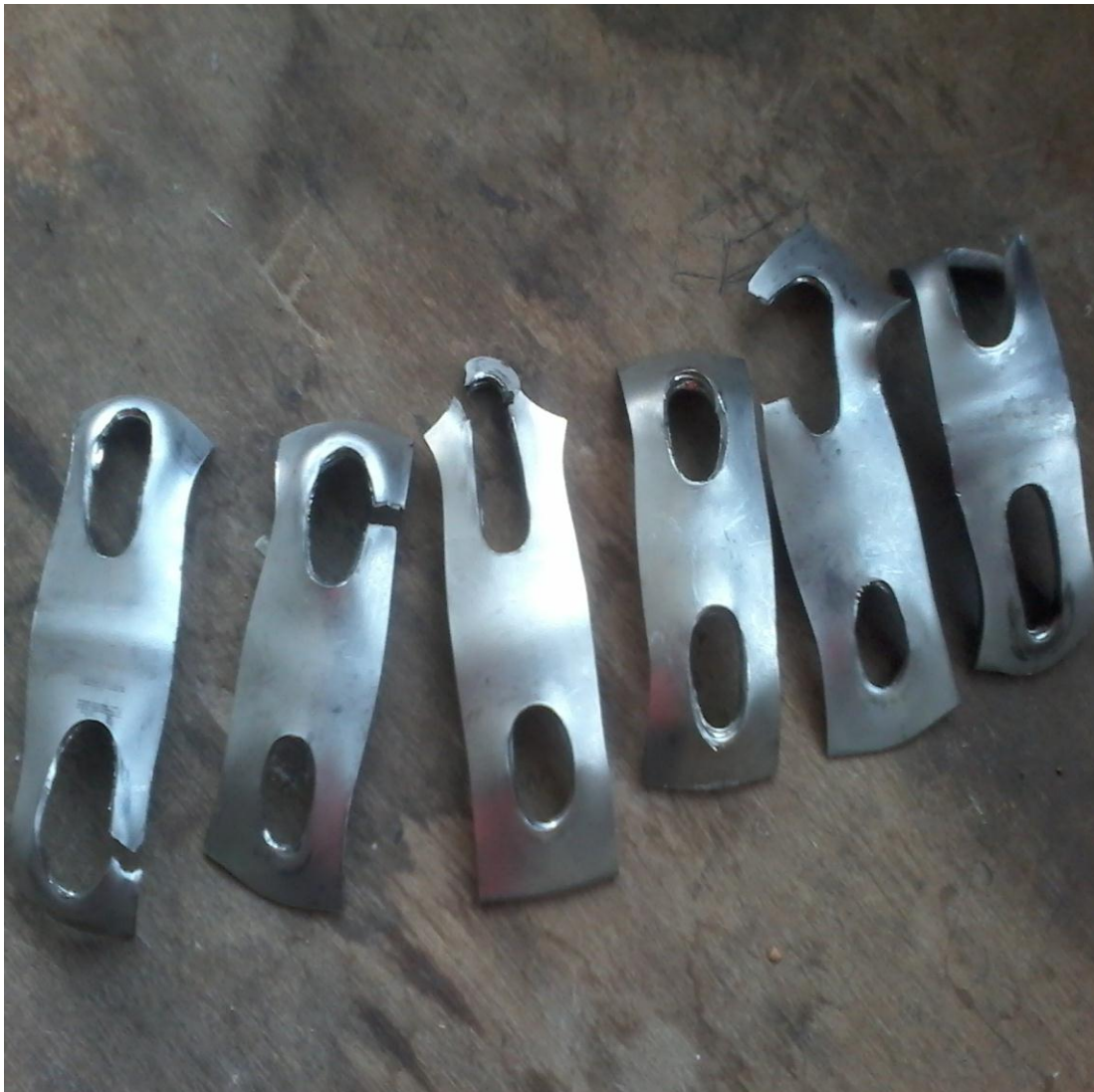
Figure III.4. : Les éprouvettes après dépliages.
