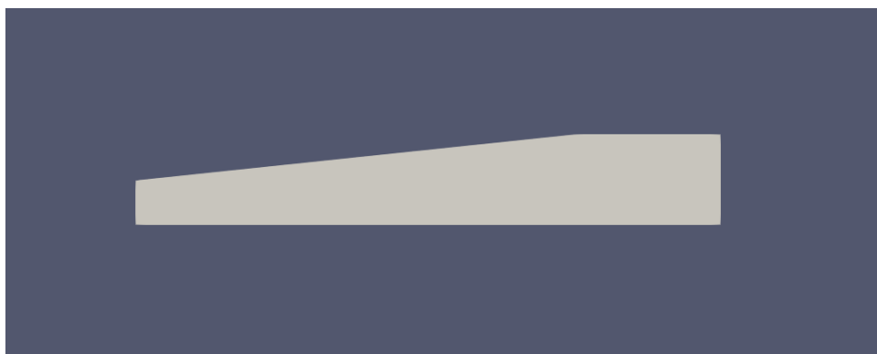
Figure 4.5 : convergence rectiligne avec OpenFoam
