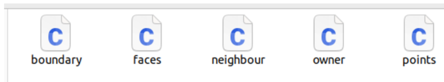
Figure 3.8 : Contenu du sous-répertoire polyMesh
