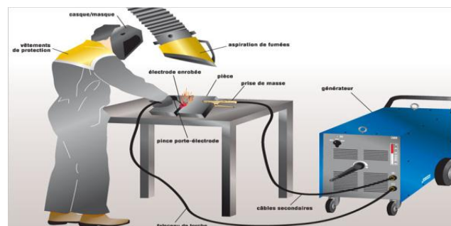
Figure II.3. Poste a soudage à l'arc à l'électrode enrobée. [8]
