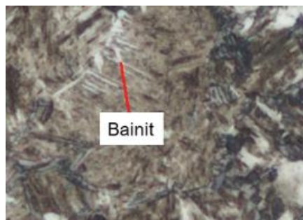
Figure I.5. Micrographie de bainite .[5]
