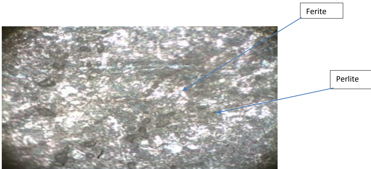
Figure IV.3. Microstructure du métal de base R260 , G.X200
