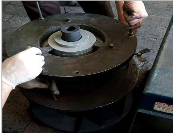
**Figure I.22. Fixation de l'outillage de centrage du Blank.**
