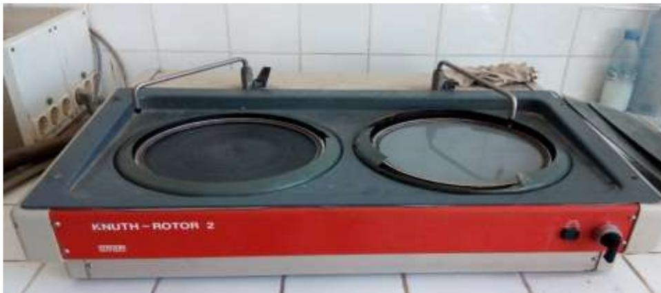
**Figure IV.23. Polisseuse électrique à deux disques.**
