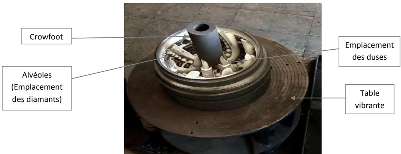
**Figure I.21. Moule déposé sur la table vibrante.**
