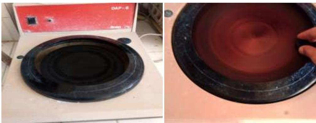
**Figure IV.24. Polisseuse de finition.**
