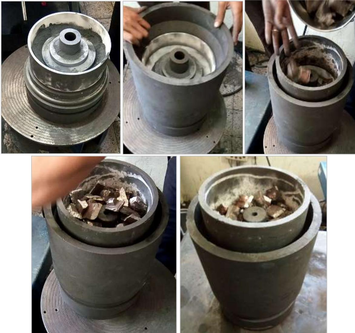
**Figure I.24. Remplissage du moule.**
