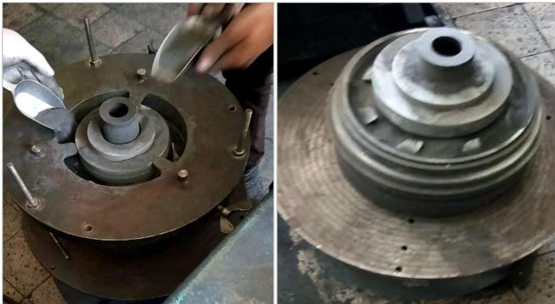
**Figure I.23. Remplissage du moule par les poudres.**
