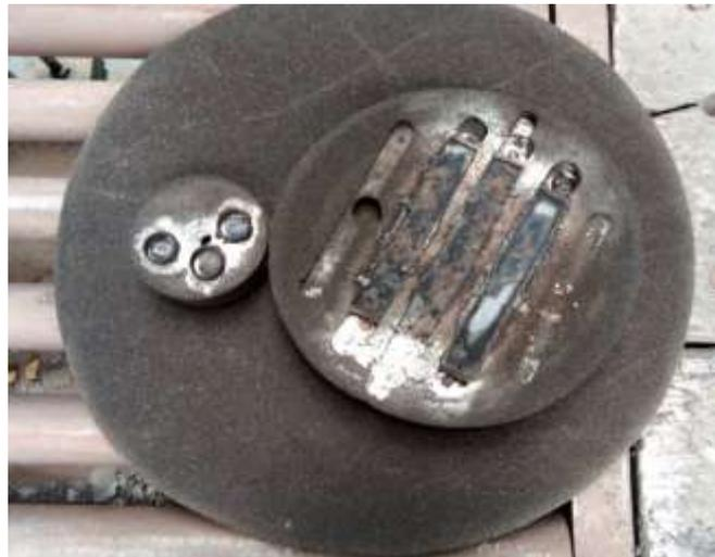
**Figure IV.20. Moules après infiltration dans le four conventionnel**
