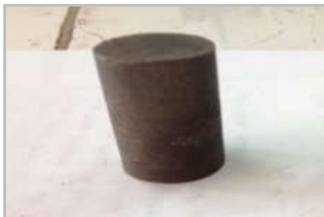
**Figure IV.16. Eprouvette de compression après sablage et meulage.**
