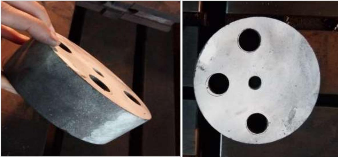
**Figure IV.12. Moule pour éprouvettes de compression.**
