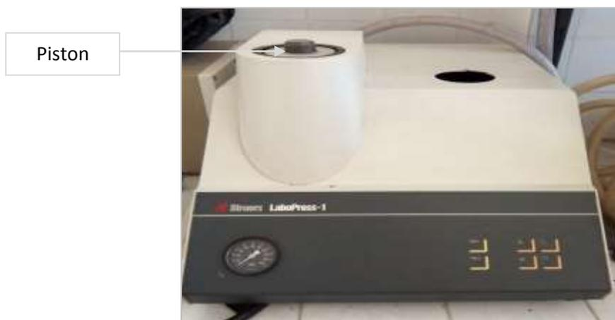
Figure IV.21. Enrobeuse à chaud
