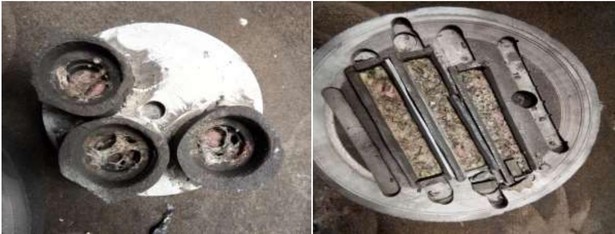
**Figure IV.15. Moules des éprouvettes de compression et de traction après infiltration.**
