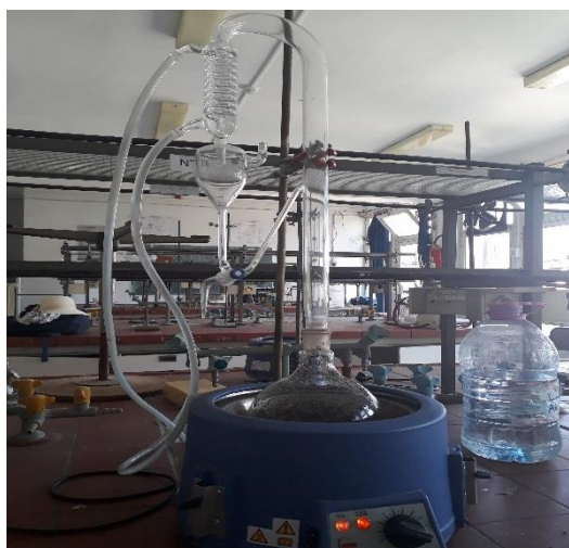
Figure 29 : Appareil de type Clevenger (Laboratoire de chimie, 2019).
