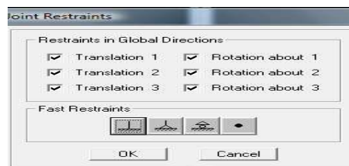
Figure IV.35 : encastrement des appuis
