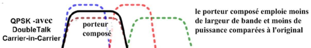
Figure 4.7 : signal composé avec une réduction de spectre et de puissance.
