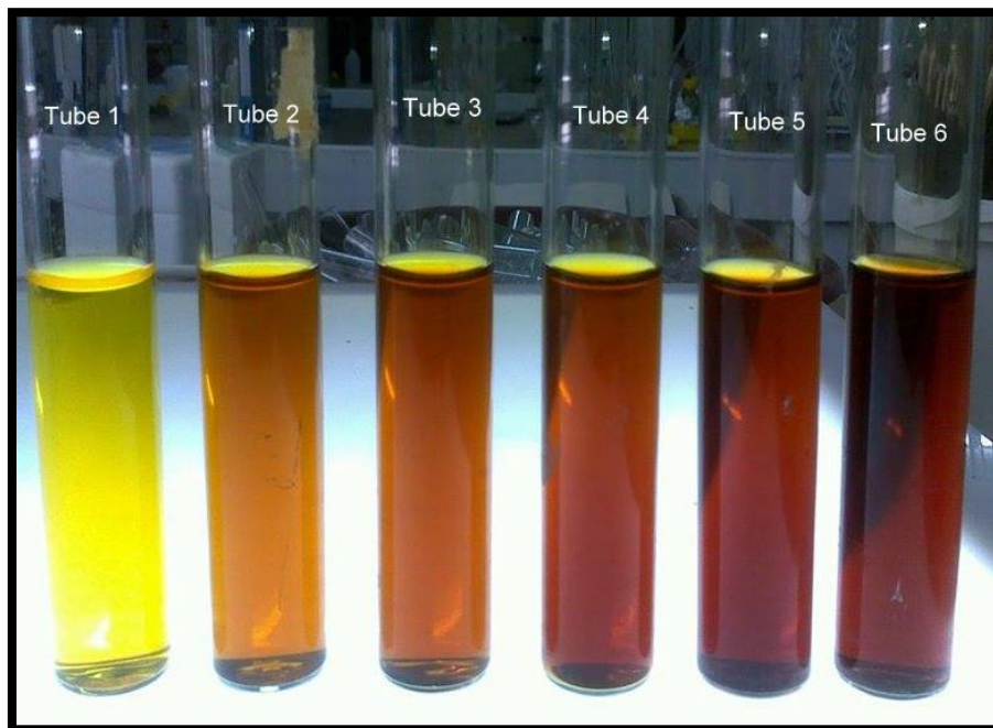
Figure 21: Photographie prise après incubation des tubes à 100°C durant 5min pour le dosage du glucose, la couleur est proportionnelle à la concentration en glucose.
