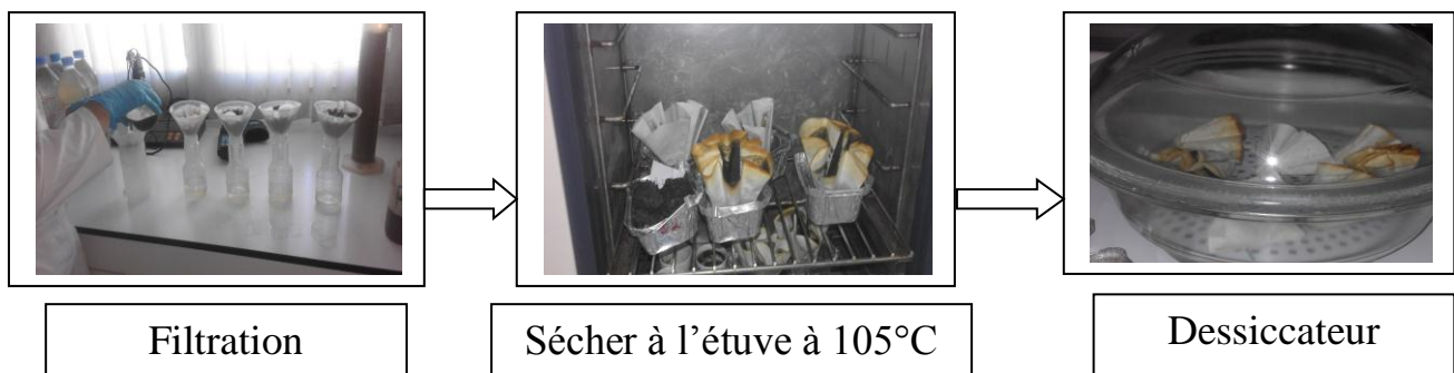
Figure 5 : Séchage des boues à l'étuve
