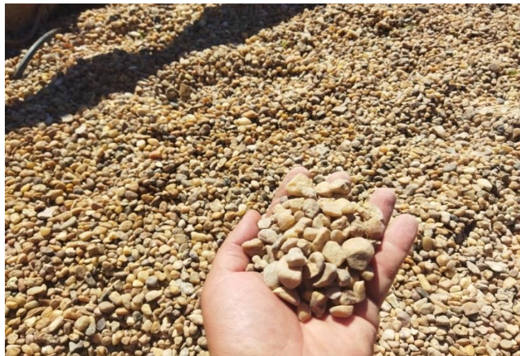
Figure 61 : Le massif filtrant de 3mm de diam tre
