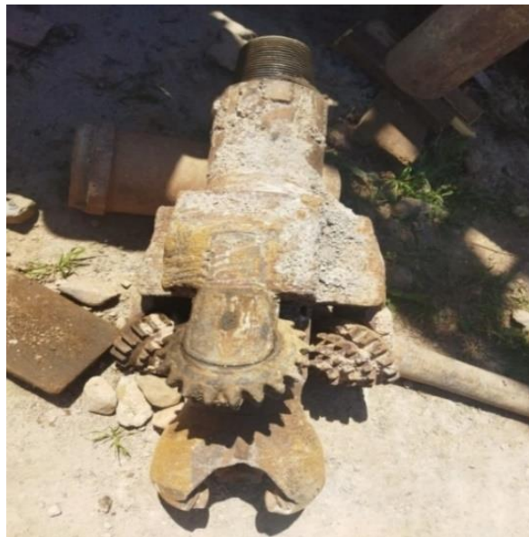
Figure 52 : L'alésure (tricône 19 pouces)
