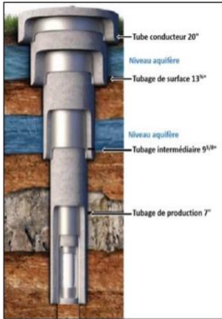
Figure 04 : principe d'isolement des aquifères par tubage cimenté
