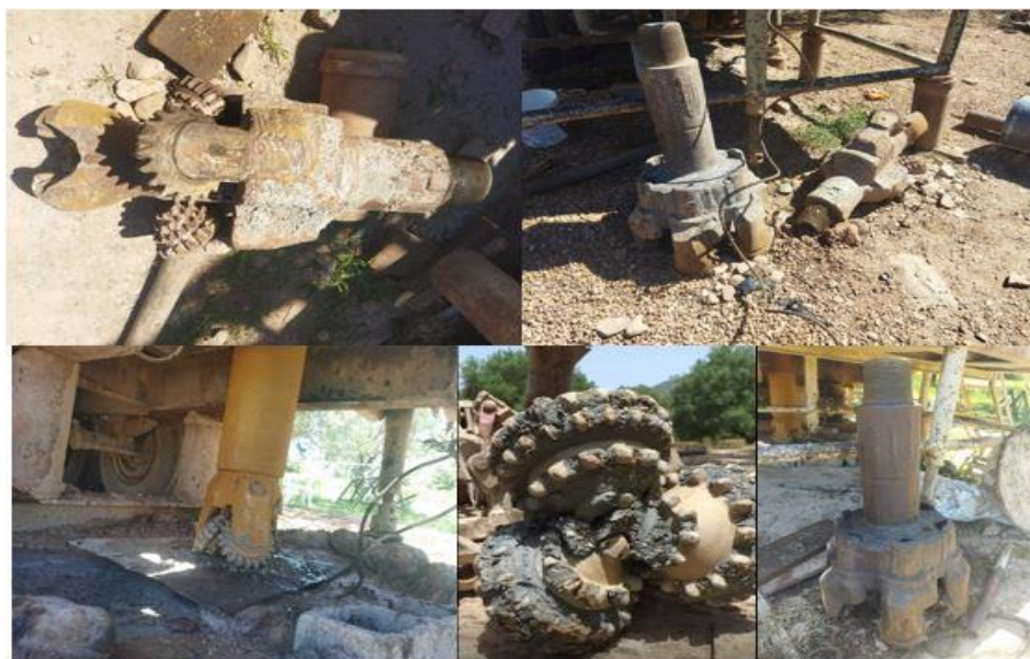
Figure 51 : les outils (tricône) de 12 et 17 et 19 pouces
