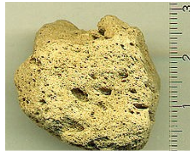
Figure II.12 : Échantillon de pierre ponce hautement poreuse du volcan de Teide à Tenerife, Îles Canaries. La densité de l'échantillon avoisine les 0,25 \text{ g/cm}^3 . L'échelle est en cm
