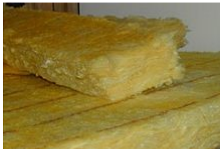
Figure II.16 : Laine de verre utilisée comme isolant [15]
