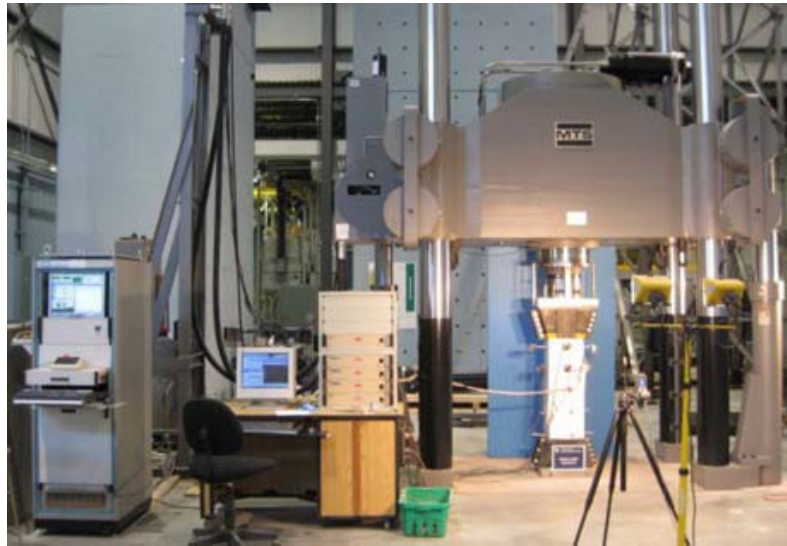
Figure IV.9: Dispositif expérimental des essais sur poteaux [6].
