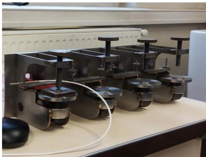
Figure III-14 : Configuration de la mesure avec le système Hot Disk
