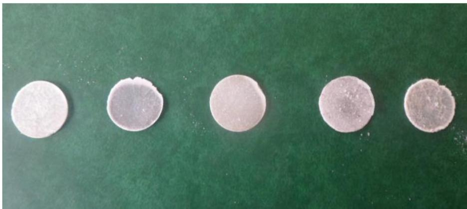
Figure III-7 : la forme finale des pastilles composite KBr pour le test FT-IR
