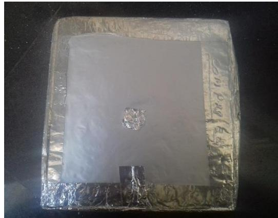
b) Plaque de composite MCP enrobée d'un film d'aluminium
