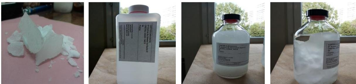
h) Paraffine (MCP1) i) CrodaTherm21(MCP21) j) CrodaTherm24(MCP24) k) CrodaTherm29(MCP29)
