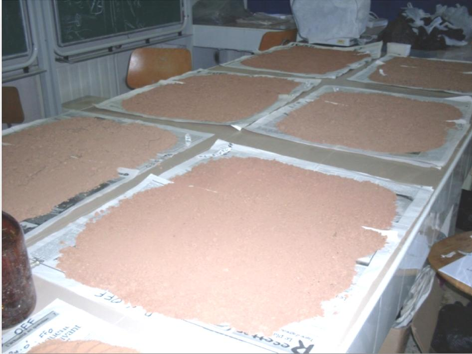
**Fig. 22.** Échantillons de sols de dayate El Gouffa, étalés et séchés au laboratoire.
