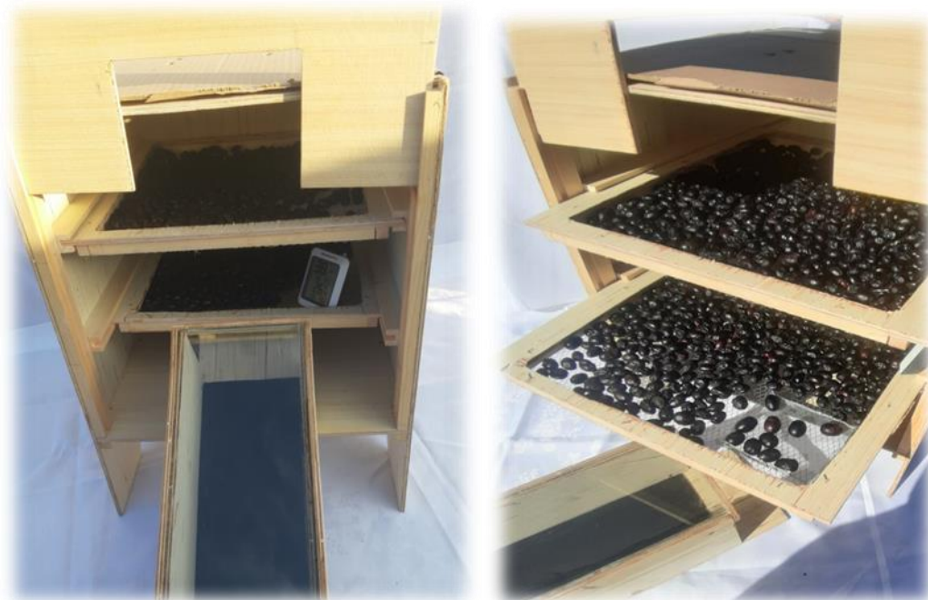
Figure 15 : Photographie du séchoir solaire indirect.
