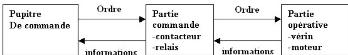
Figure I-4 Positionnement du pupitre dans un système automatisé.
