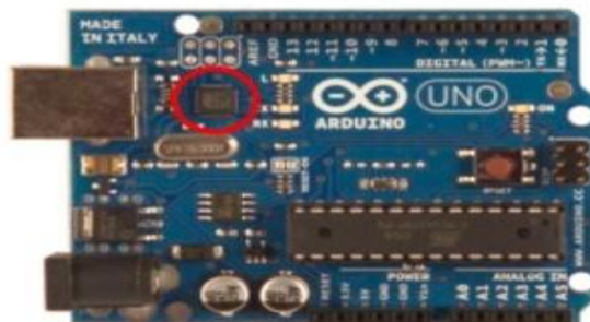
Figure (IV. 15) : Circuit émulateur du port série
