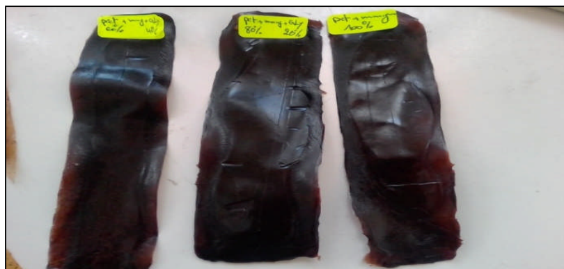
Figure 5.9. Films à base de pectine/margine etpectine/margine/glycérol.
