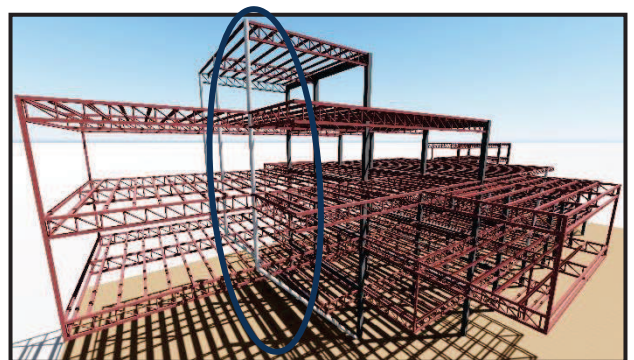
Fig 108 : poteaux métalliques Source : Auteurs
