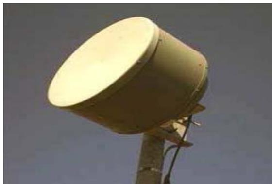
Figure II.11: Antenne d'un faisceau hertzien
