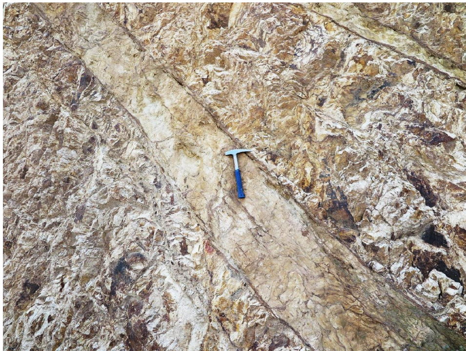
Figure II.7: discontinuités du métagranite dans le tunnel d'Ait Yahia Mousa, vue de près.
