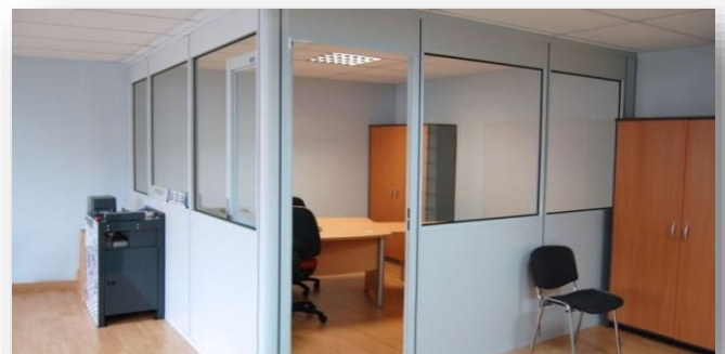
Fig.: cloison amovible en aluminium /verre source: https://www.google.dz/ .
