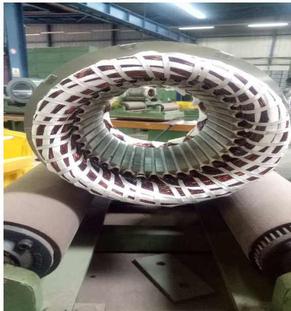
Fig.III.05 stator après frettage et pressages des câbles.
