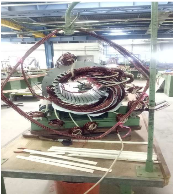
Fig.III.03 Opération de bobinage
