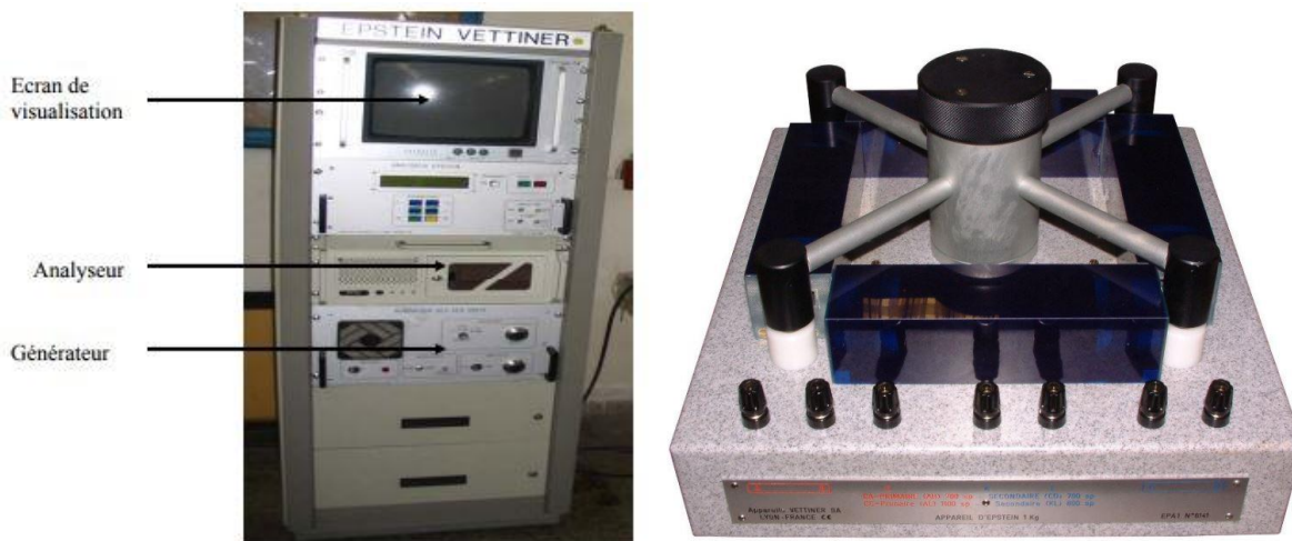
Fig.IV.06 Appareil Vettiner avec ses 3 compartiments ainsi que le cadre d'Epstein.
