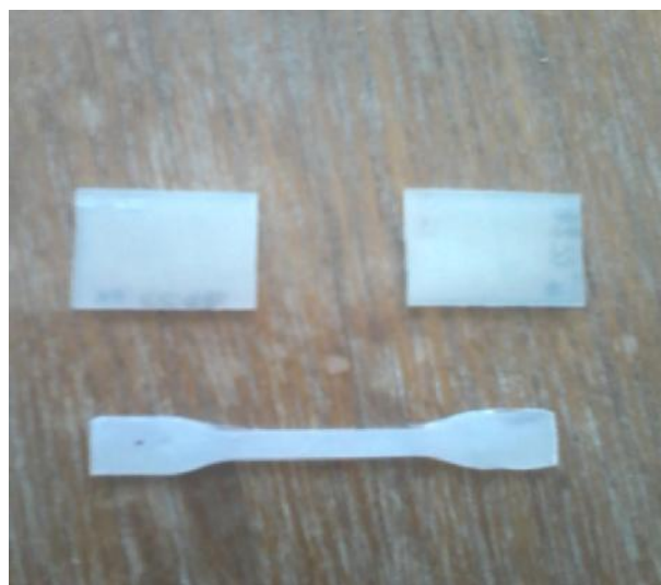
Figure III.4 : Eprouvette carrée et sous forme d'haltère
