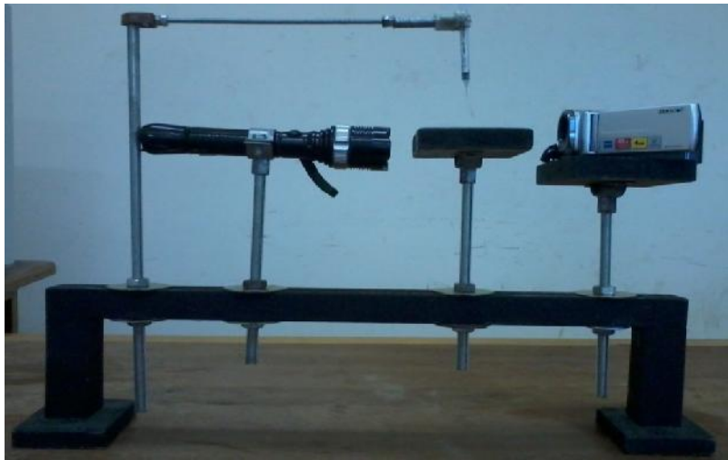
Figure III.9 Dispositif utilisé pour la mesure de l'angle de contact.
