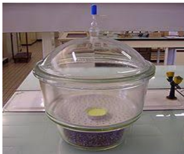
Figure III.6 : Dessiccateur pour conditionnement des éprouvettes.
