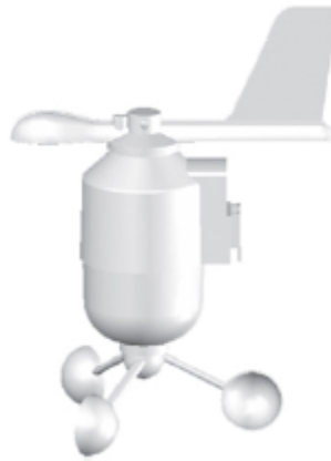
Figure II.5 : Capteur pour la mesure de direction et vitesse de vent
