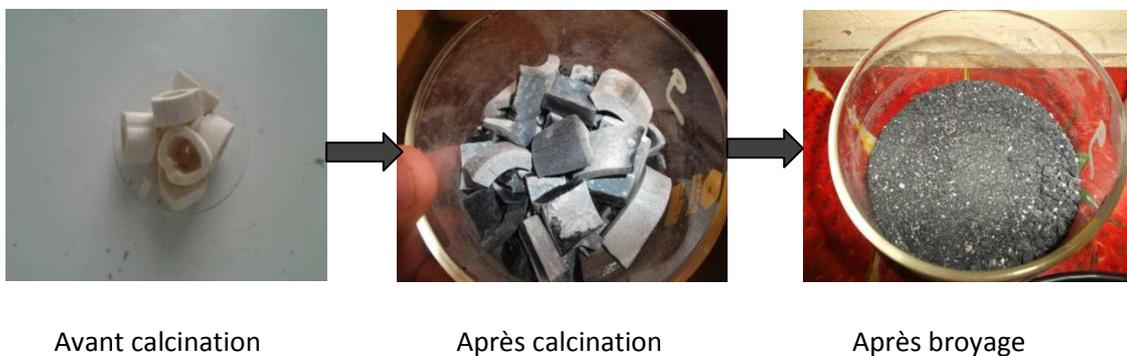
**Figure III.1** : Os de bœuf avant et après calcination et broyage.
